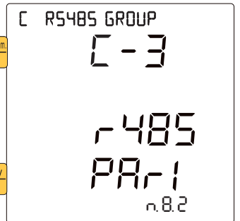
Parity check setting: N.8.1 / N.8.2 / O.8.1 / E.8.1
